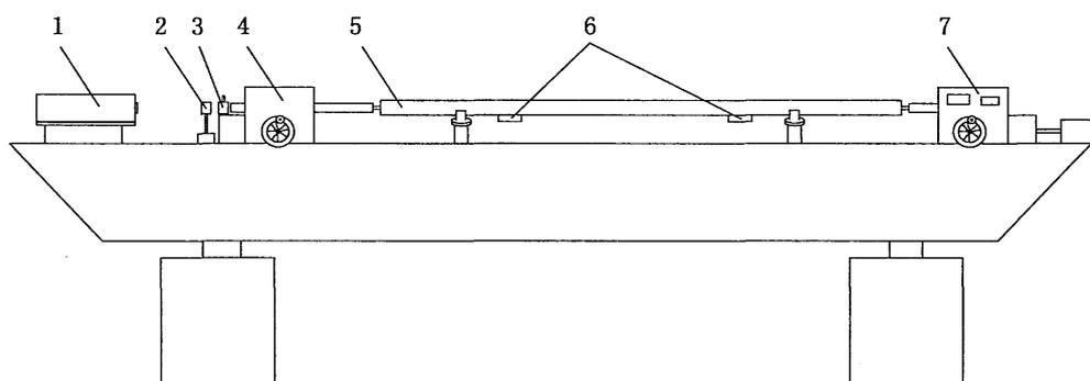
图 C.2 激光干涉仪安装在测长机机体上
