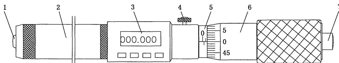
图3 数显接杆内径千分尺示意图
