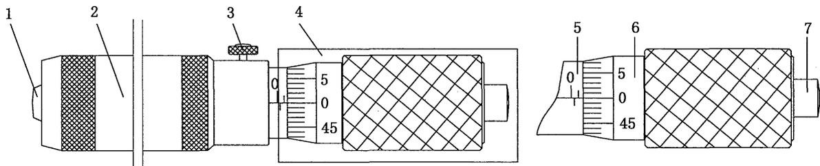
图 1 接杆内径千分尺示意图
