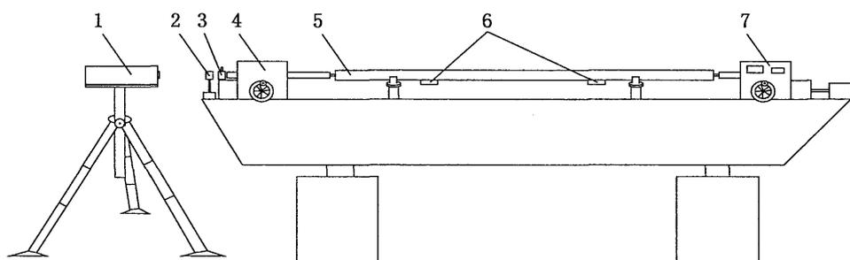
图 C.1 激光干涉仪安装于测长机之外
