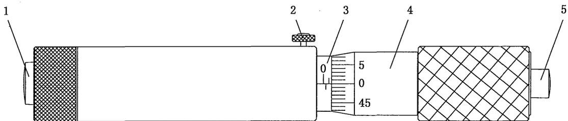
图 2 单杆内径千分尺示意图
