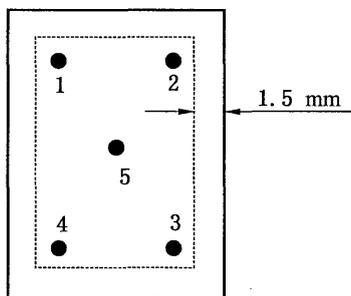
图 6 校对用的卡规测量位置示意图
