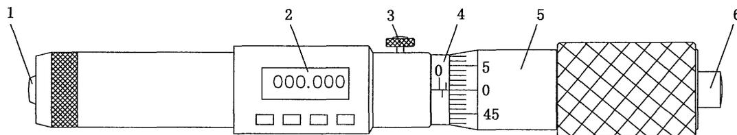
图4 数显单杆内径千分尺示意图
